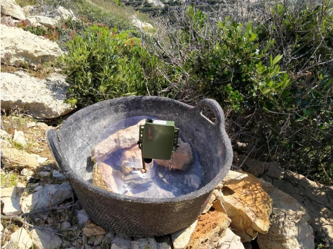
**Figura 2.** Equipo de grabación. La grabadora se situó pocos centímetros por encima de una parábola de metacrilato transparente (7 cm en concreto, que es la medida más adecuada para este tipo de parábola), sujeta con una varilla roscada. Todo el equipo se ubicó dentro de un capazo de goma, lastrado con piedras para que el viento no tambalease.
